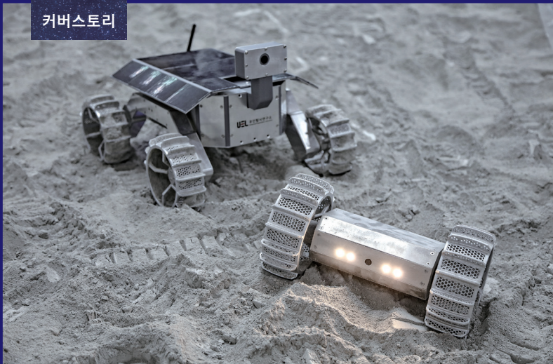
무인탐사연구소는 탐사 로버가 인공 월면토를 달리는 실험을 통해 바퀴 형태를 연구·개발해오고 있다. 사진 무인탐사연구소
